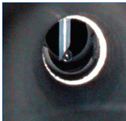
Rysunek 2. Podajnik automatyczny AS 900 dozujący kroplę wody w rurce grafitowej THGA pokazywany za pomocą kamery pieca TubeView.
