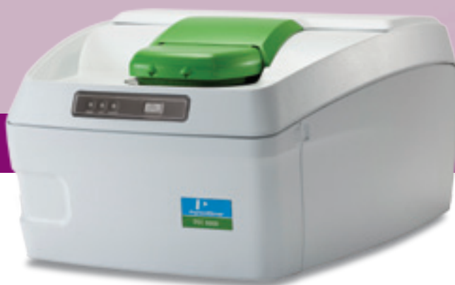
Kalorymetr DSC 8000 bez automatycznego podajnika próbek
